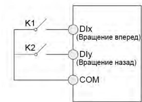
Это режим, в котором прямое/обратное направление вращения двигателя задается с помощью входов DIx и Dly. Настройка параметров указана ниже:
