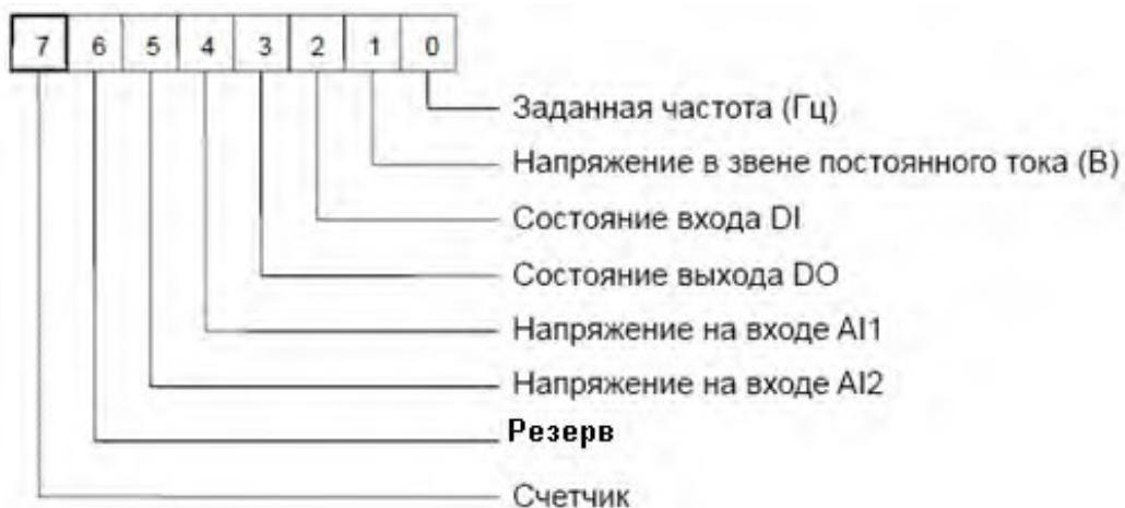
Если необходимо, чтобы соответствующая информация отображалась во время остановки, установите соответствующий бит в значение 1 и задайте значение параметра P7.04 в виде шестнадцатеричного числа, которое соответствует этому бинарному коду.
